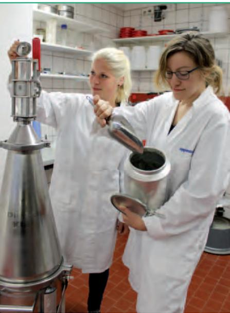
Abb. 3: Doktorandin Dipl.-Biol. Isabella Schrank und Masterstudentin Lena Löschel bei der Aufbereitung von Sedimentproben mit dem Munich Plastic Sediment Separator. Dieser ermöglicht es, Mikroplastikpartikel zuverlässig von Sediment abzutrennen (Foto: Christian Wißler).
