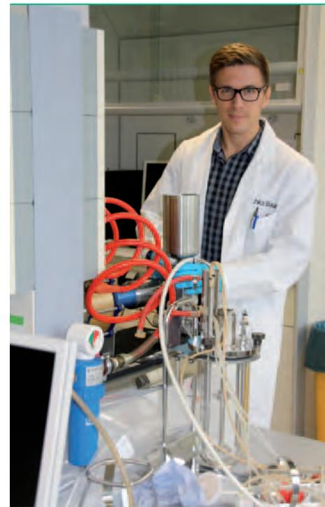
Abb. 2: Die Spinnenseidenproteine werden rekombinant in Bakterien hergestellt. Um an die Proteine zu gelangen, schließt Joschka Bauer M.Sc. die Zellen mit Hilfe eines Hochdruck-Homogenisators auf (Foto: Christian Wißler).
